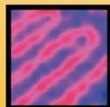
Wärmebild einer konventionellen elektrischen Bodenheizung links nach ca. 5 min. rechts nach ca. 45 min.
